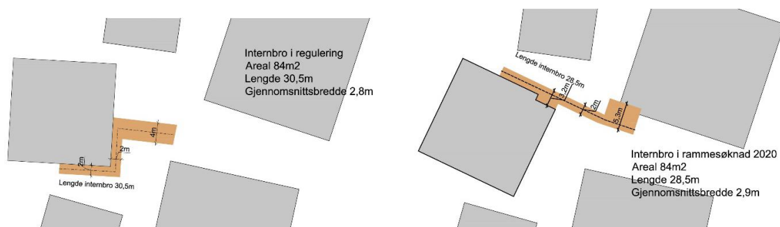
Figur 11: Som figuren viser, vil den foreslåtte løsningen resultere i en bro med større gjennomsnittsbredde enn den regulerte.
