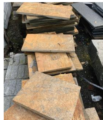
Figur 10: Otta Rust. Andelen rust i steinen vil variere.
