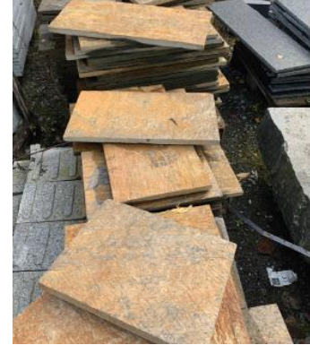
Figur 10: Otta Rust. Andelen rust i steinen vil variere.
